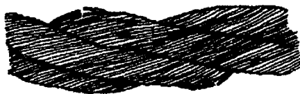
Рисунок 1. Обрывы и смещения проволок каната крестовой свивки
