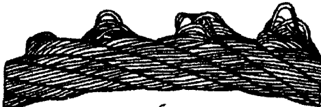
Рисунок 12. Выдавливание проволок прядей: а - в одной пряди; б - в нескольких прядях
